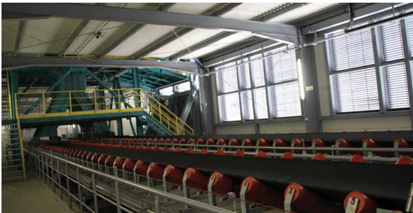
Transportna trakova premoga proti bloku 6; foto: Arhiv TEŠ
