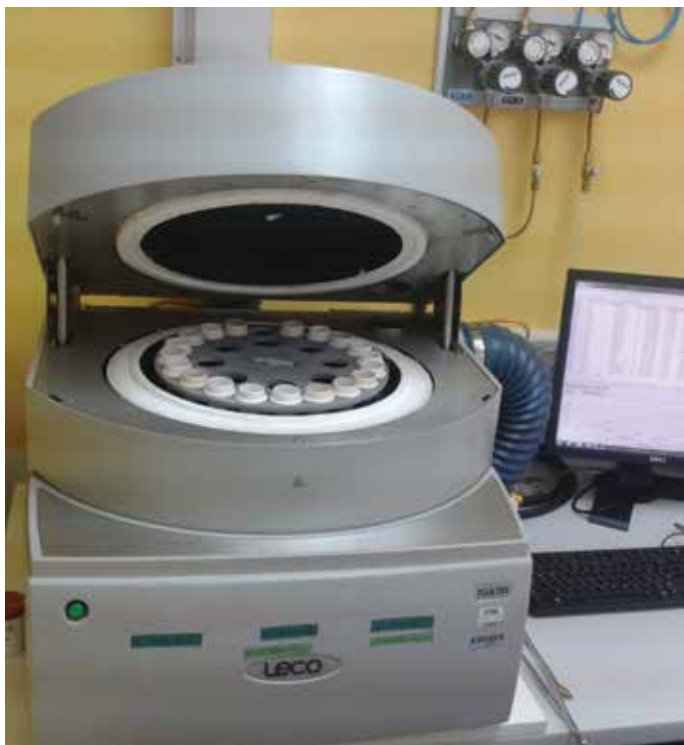
Termogravimeter LECO TGA701; foto: Arhiv TEŠ
